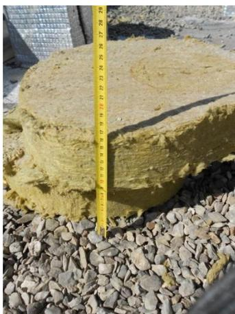
*Isolation de toiture en laine de roche sous étanchéité (réduction des impacts par rapport à du polyuréthane)*
