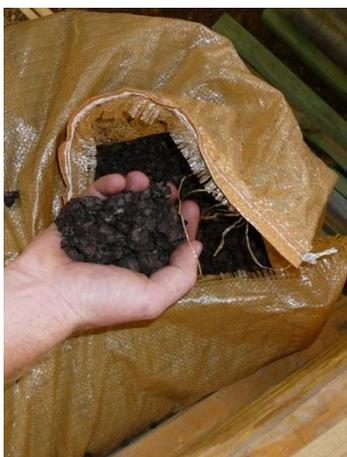
*Isolant liège expansé en vrac pour remplissage d'une ossature bois.*
