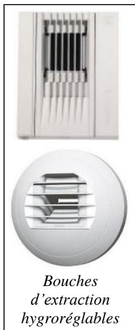
**Ventilation mécanique contrôlée simple flux hygroréglable** : ce système ingénieux permet de réduire les débits de ventilation lorsque les occupants sont absents de leur logement. Les bouches d'extraction (et les entrées d'air pour l'hygro B) sont sensibles à l'humidité dégagée par la présence humaine, et restent sur un débit minimal lorsque l'humidité est faible.
